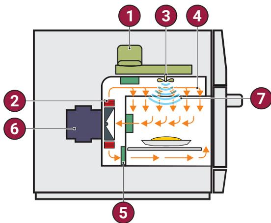
1. Magnetron (generador de microondas)
